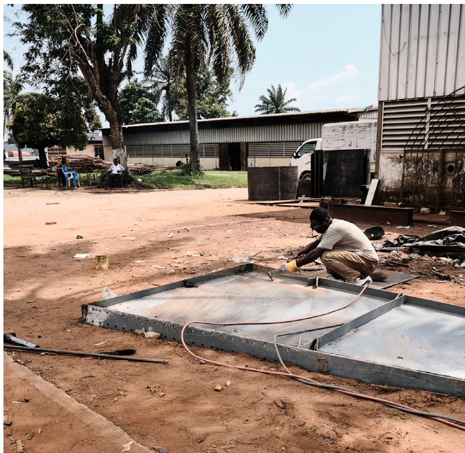
Figure 10. Étudiant effectuant un travail pratique de soudure à l'extérieur d'un établissement de l'ETFP (Photo : Lavigne, 2018)
